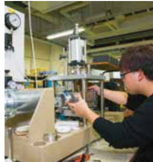
鳥海山から採取した泥炭堆積物に対して定体積一断面試験を行う様子
