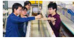
流木の堆積に関する水理模型実験
