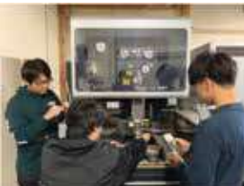
ワイヤカット装置による 試験片の精密切断
