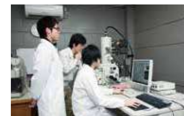
〈写真3〉 電界放出型走査電子顕微鏡を用いた各種高機能材料表面の高分解能(ナノメートルスケール)での微細組織観察の実験風景
