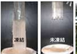
通常品 開発品 熱源がなくても凍結を抑制できる排水管
