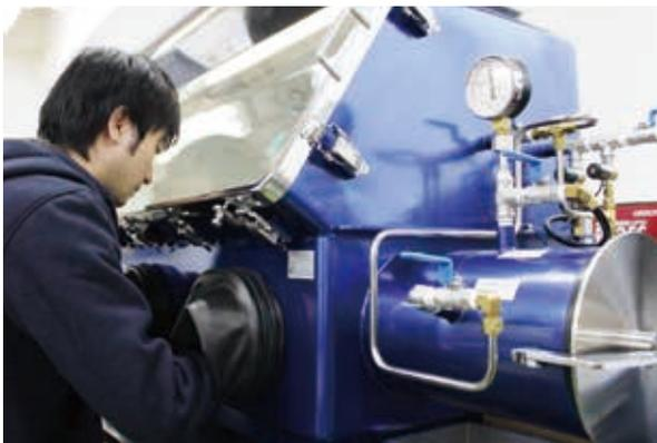
電池の組み立て工程
