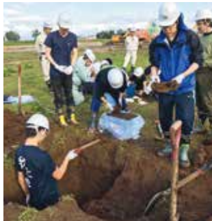
泥炭性軟弱地盤の調査と試料採取の様子
