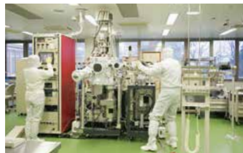
写真1:クリーンルーム内に設置されている超高真空対応薄膜作製装置を用いた高機能薄膜試料の作製風景
