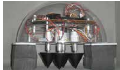
水面を移動しながらミストを放出する流体機構
