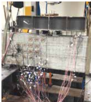
鉄筋コンクリートはりの載荷実験
