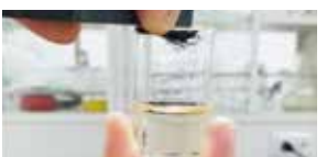
染料物質を吸着後、 吸着材を磁石で回収
