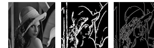
アリの群れが餌場までの最短経路を見つけるアルゴリズム(ACO法)の画像エッジ検出への応用と標準的手法(Canny法)の比較
