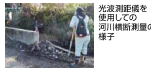
光波測距儀を使用した河川横断測量の様子
