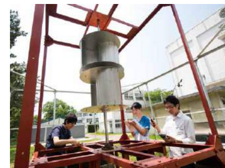
小型サボニス風車の実験
