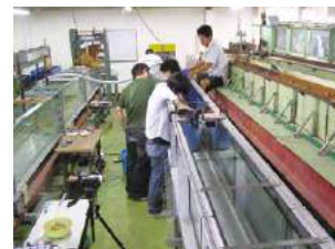
津波漂流物を伴う氾濫流実験の様子
