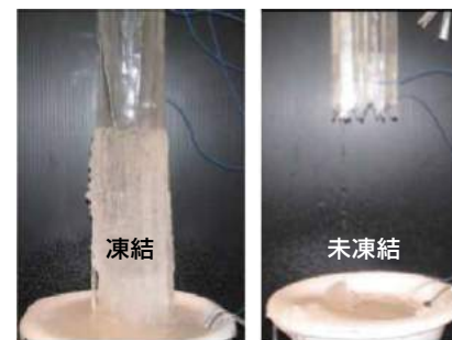
通常品 室温-20°Cでも凍結しないで水を流すことができる排水管
