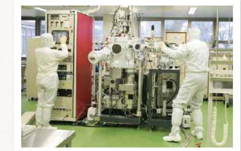
図1: クリーンルーム内に設置されている超高真空対応薄膜作製装置を用いた高機能薄膜試料の作製風景
