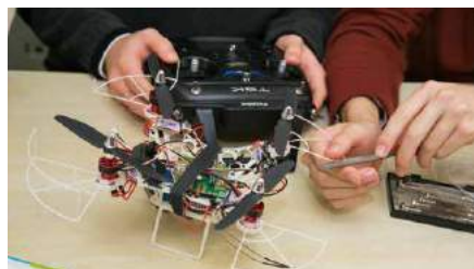
3Dプリンタで製作した部品を組み込んだドローン
