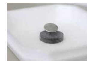
超伝導マイスナー効果による磁気浮上 素粒子論のヒッグス機構と同じように、対称性の自発的破れが電磁場に質量を与えたと説明できる現象
