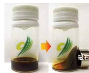
(左)マグネタイトナノ粒子からなる磁性流体 (右)磁石に引き寄せられる磁性流体
